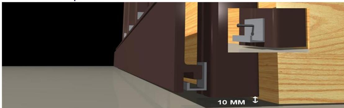
Schrauben Sie das Wandpaneel an der oberen Feder mittig an den WPC-Balken.
