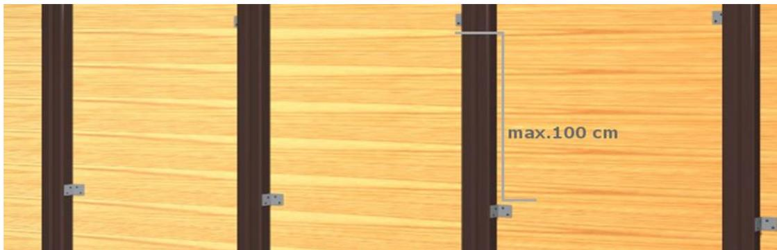
Befestigen Sie die Unterkonstruktionsbalken in regelmäßigen Abständen von max. 100 cm auf dem Untergrund (bei Verwendung von Winkeln, diese bitte versetzt anbringen). Beginnen und enden Sie mit der Montage immer an einem Ende des Balkens. Stellen Sie sicher, dass der Raum zwischen der Konstruktion frei ist, damit eine Luftzirkulation gewährleistet ist.
